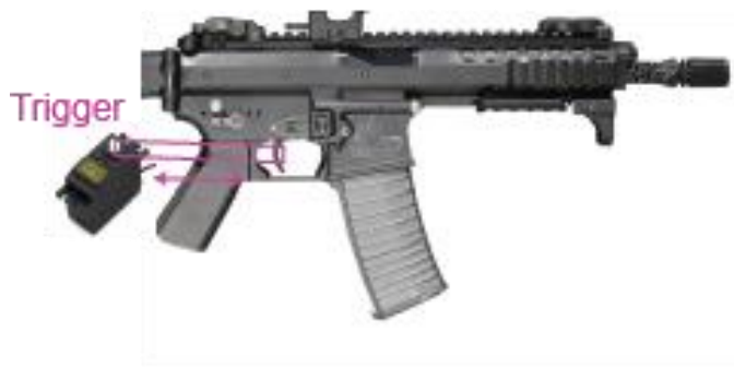
Gambar 3.8 Ilustrasi pergerakan motor servo pada saat menarik trigger
