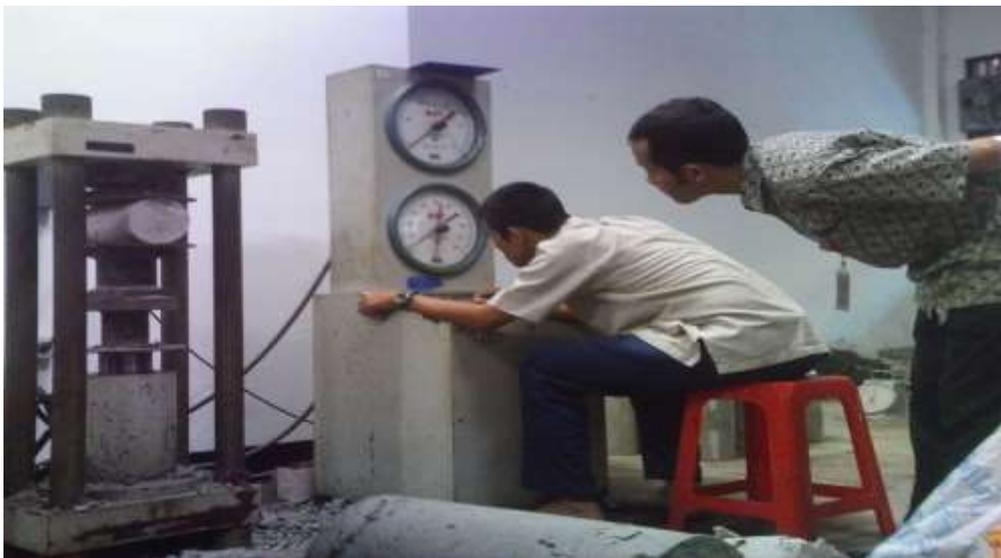
**Gambar 7:** Pengambilan kuat belah beton dengan alat *Compression Test Machine*
