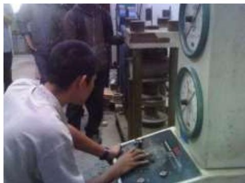
**Gambar:** Pengambilan uji belah beton dengan alat *Compression Test Machine*
