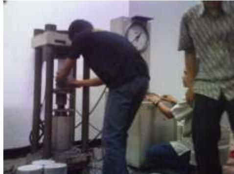
**Gambar:** Pengambilan kuat tekan beton dengan alat *Compression Test Machine*
