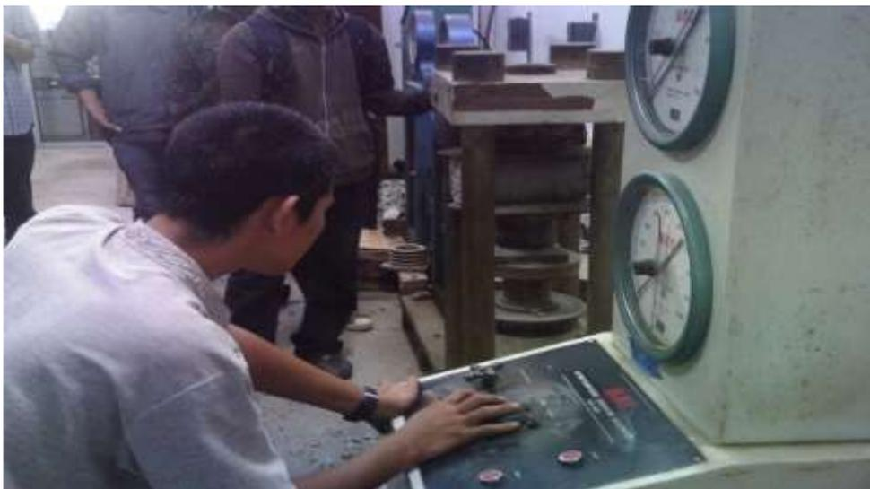
**Gambar 6:** Pengambilan kuat belah beton dengan alat *Compression Test Machine*
