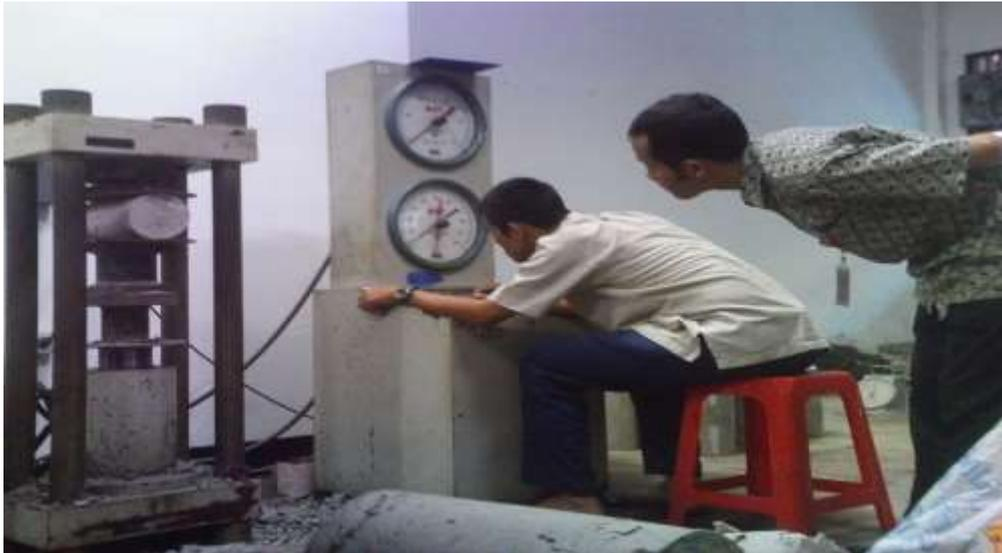
**Gambar 3:** Uji Belah dengan Alat *Compression test machine*.
