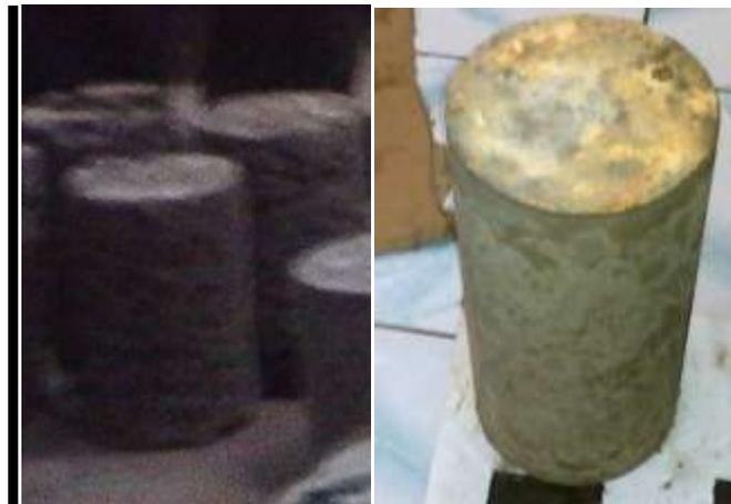
**Gambar:** Beton tetes tebu baru umur satu hari cetakan dibuka (kiri) dan umur minggu cetakan beton dibuka (kanan).
