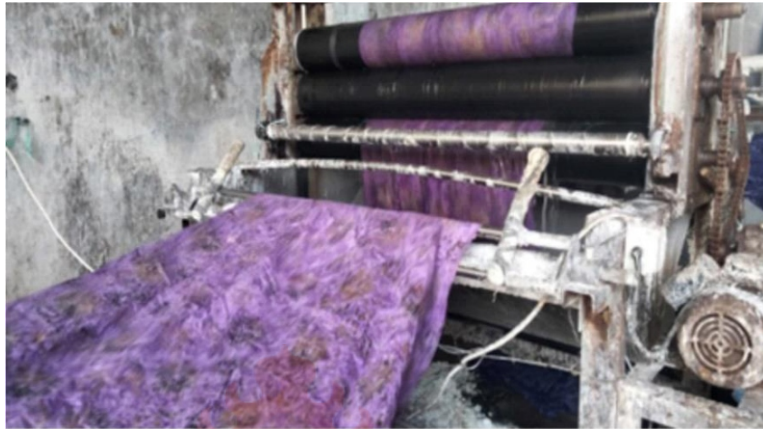
Gambar 9. Proses Pencucian Warna Menggunakan Water Glass Sumber (Foto Safitri Nurjannah, 2024)
