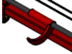
Gambar 4. 11 Pengait Beam Tenun
