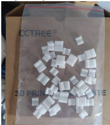
Gambar 8. Material TPU/ Flex Filament sebagai Jointer
