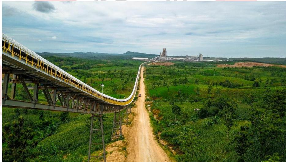
Gambar 2. 8 Long belt conveyyor yang ada di PT. Semen Gresik Pabrik Rembang
