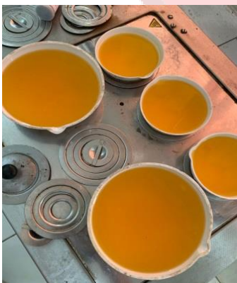
Pengentalan Ekstrak Menggunakan Waterbath
