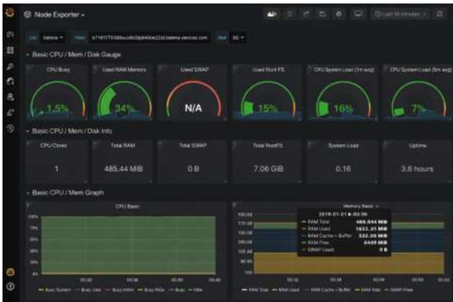
Gambar 17. Dashboard Monitoring Kinerja dan Infrastruktur Sistem menggunakan Prometheus dan Grafana (Node Exporter)
