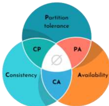
Gambar 14. Visualisasi CAP Theorem dan trade-off antara Consistency, Availability, dan Partition Tolerance dalam sistem terdistribusi.
