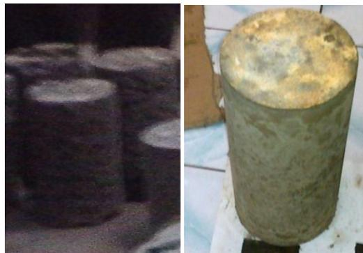
**Gambar 2.** Beton tetes tebu baru umur satu hari cetakan dibuka (kiri) dan umur satu minggu cetakan beton dibuka (kanan).
