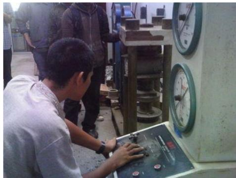
**Gambar 4.** Pengambilan uji belah beton dengan alat *Compression Test Machine*
