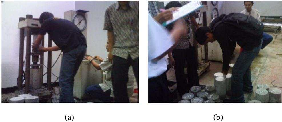
**Gambar 3.** Pengambilan kuat tekan beton dengan (a) alat *Compression Test Machine* dan (b) alat *Hammer Test*
