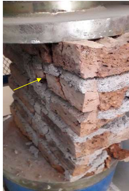
Gambar 4. Retakan batu bata uji 0^\circ
