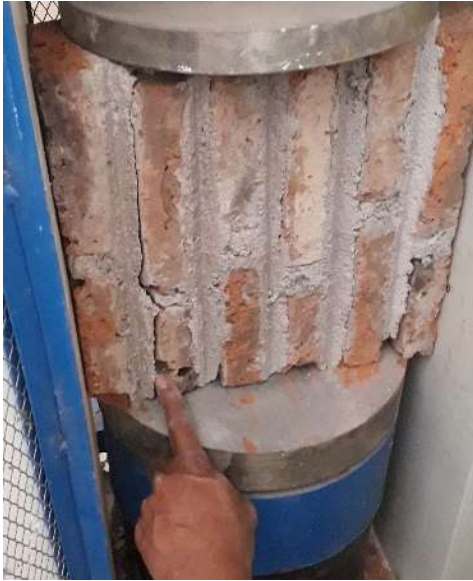
Gambar 6. Retakan batu bata uji 90°
