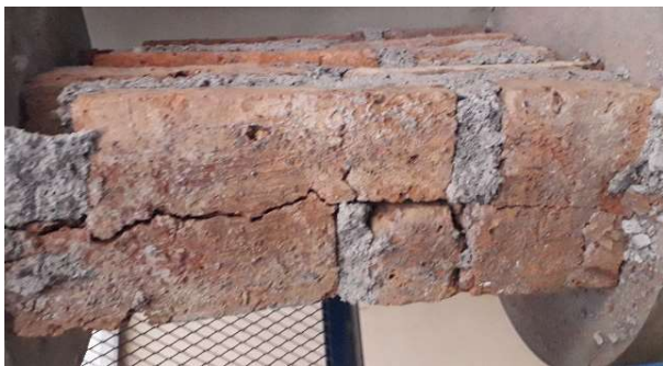
Gambar 7. Arah retakan membelah batu bata pada uji 90°
