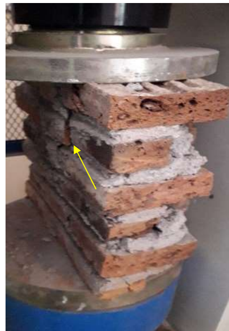
Gambar 5. Retakan batu bata uji 0^\circ
