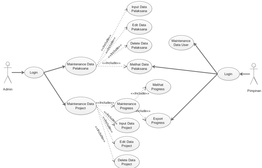
Gambar 3.3 Use Case Diagram Aplikasi Pendataan Biaya Bahan Baku Proyek CV. RNK Contractor
